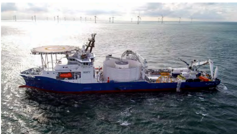
NKT Victoria: eigenes modernes Kabelverleges Schiff für Seekabel, 140 Meter lang, 9000 Tonnen Ladekapazität. Verlegt 525 Kilovolt-Gleichstromkabel in Wassertiefen bis zu 400 Metern. Mit einem Pflug wird das Höchstspannungskabel rund 3 Meter tief im Meeresboden versenkt.
